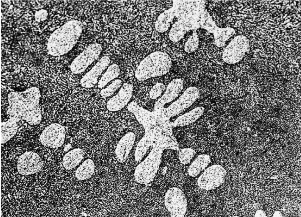
Bild 3: Gefüge einer mit Strontium veredelten G-AlSi-Legierung mit 10 % Si (Kokillenguss) © GIESSEREI LEXIKON
